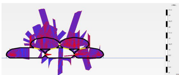
Figure 12. Effort de traction circonférentielle en kN/m au passage de la houle incidente
